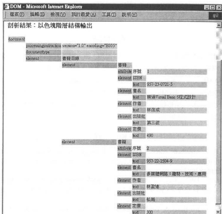
圖7 XML線上剖析器「色塊階層」輸出畫面
