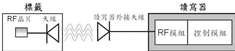
圖1 RFID系統組成元件圖
