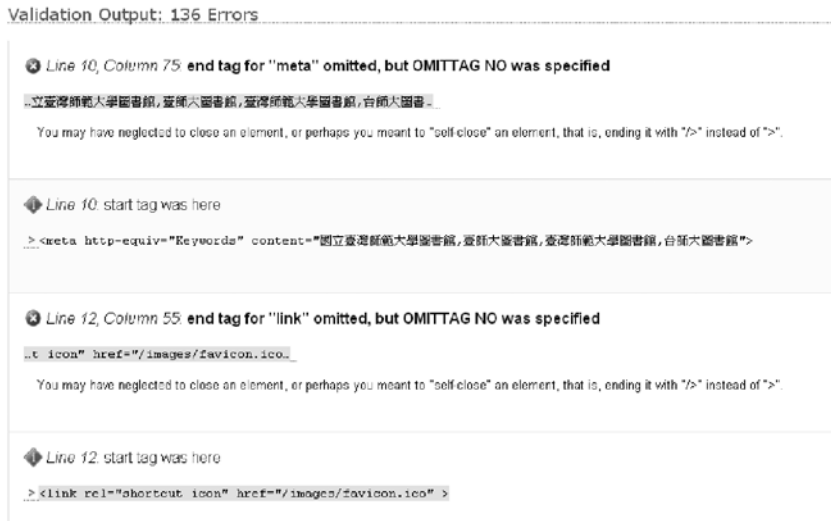
圖3 W3C Markup Validation Service 網頁檢測結果錯誤警告說明
